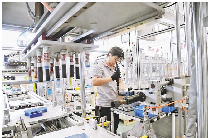
▲广西银轮环保科技有限公司车间,员工在机油冷却器总成生产线进行生产。
