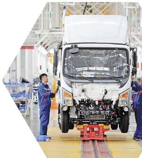
▲玉柴新能源汽车有限公司总装车间,纯电动厢式物流车正在线上组装。
