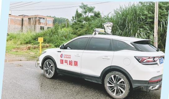
2022年7月,玉林中燃引进使用的智能燃气激光巡检车。
