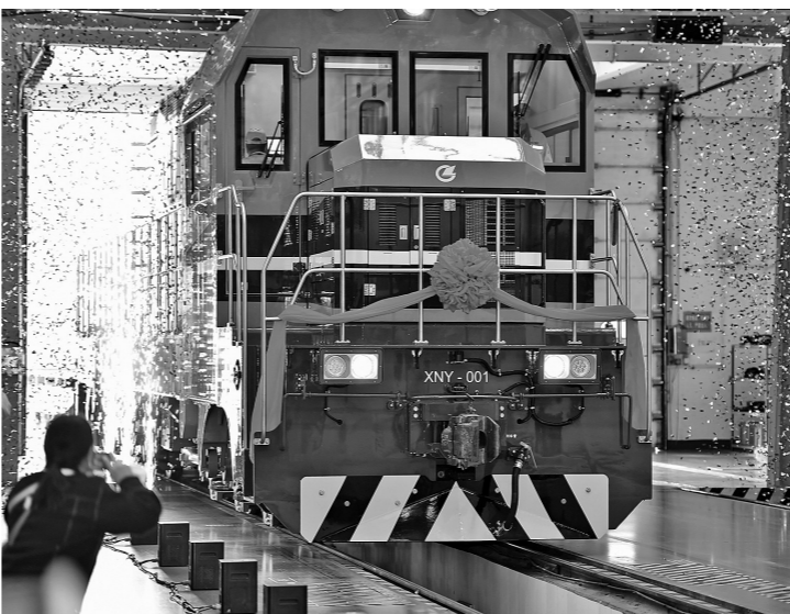
这是11月16日在中车株机公司拍摄的下线仪式现场。当日,我国首台新造大功率纯电动新能源调车机车在湖南株洲中车株机公司下线。这台机车最大牵引功率1500kW,能满足冶金、港口、电力、石化、矿山等行业内部的铁路运输需求,具有绿色低碳、经济适用、智能先进等特点。(新华社记者 陈泽国 摄)
